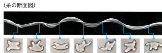
繊維面に深い溝を有する不定形断面仮撚り加工をすることで、あらゆる方向から水分を吸水・拡散。繊維軸方向にもランダムな断面形状により、繊維空間が極めて大きく、軽量感とドライタッチな質感も実現しました。
